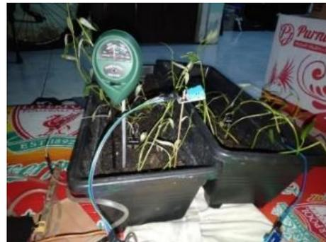
Gambar 12. Pengujian Sensor Soil Moisture
