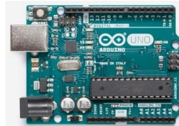
Gambar 2.1 mikrokontroler Arduino
