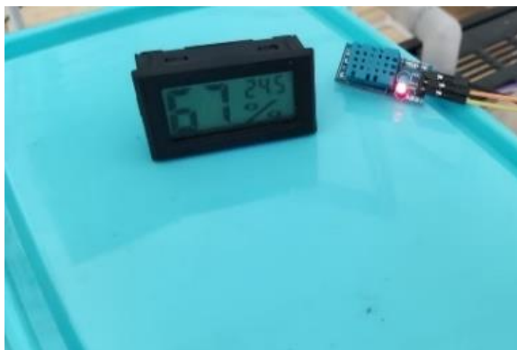
Gambar 17. Pengujian Sensor DHT-11
