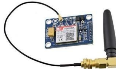
Gambar 6. Modul gsm sim800l v2
