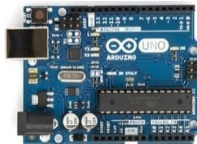
Gambar 1. Arduino uno atmega328p
