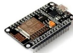
Gambar 1. NodeMCU ESP8266
