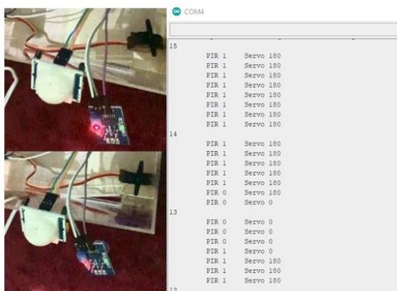
Gambar 17. pengujian sensor pir dan microservo
