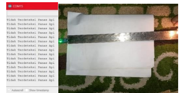
Pada Gambar 17. Pengujian Sensor Flame Detection Module Jarak 36 Cm
