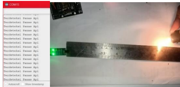
Pada Gambar 16. Pengujian Sensor Flame Detection Module Jarak 20 Cm
