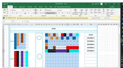
Gambar 17. Validasi keseluruhan port pada ODC
