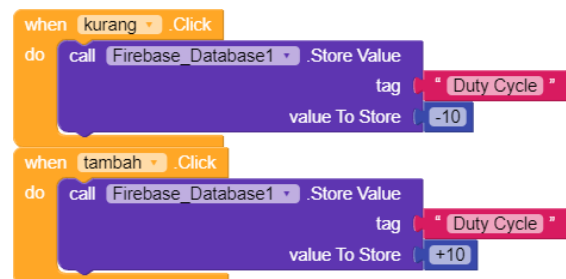
Gambar 11. Block Kodular Sistem Kontroling
