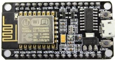
Gambar 2. Nodemcu ESP8266
