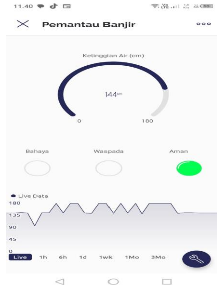
Gambar 18. Tampilan Blynk Monitor Ketinggian Air dalam Keadaan Aman
