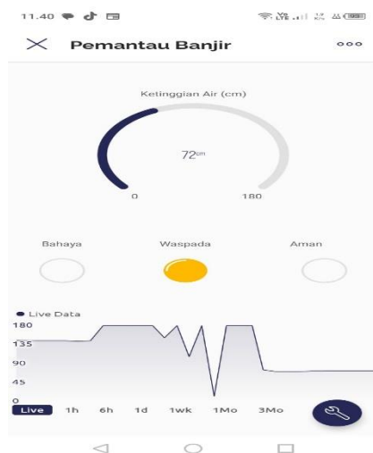
Gambar 17. Tampilan Blynk Monitor Ketinggian Air dalam Keadaan Waspada
