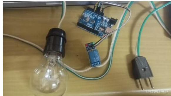
Gambar 5. Penghubungan lampu ke relay
