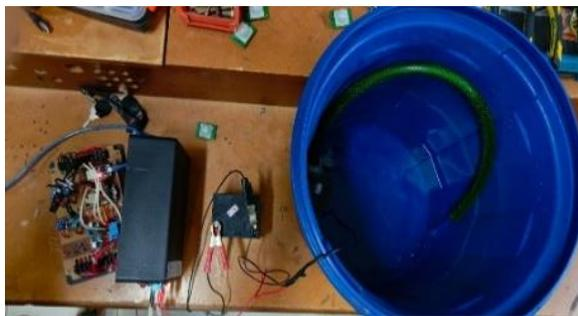
Gambar 10. Pengujian Beban Pompa Air
