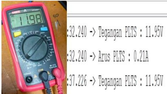
Gambar 2. Sensor Tegangan dan Multimeter
