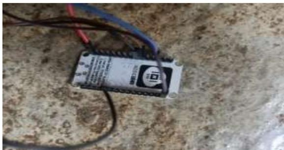
Gambar 4. Hasil rangkaian nodeMCU ESP8266
