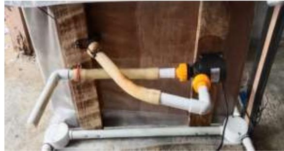
Gambar 5. Hasil rangkaian Water Pump
