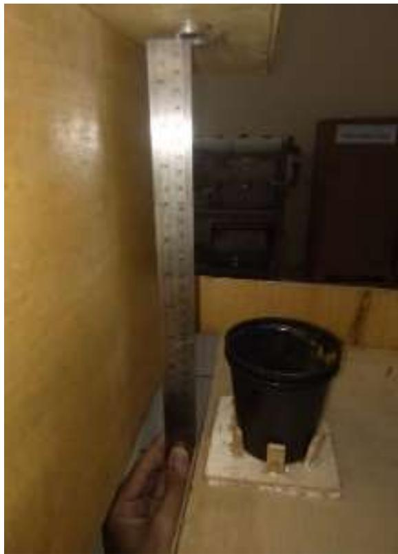
Gambar 9. Pengukuran ultrasonik menggunakan penggaris
