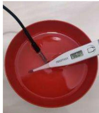
Gambar 8. Sensor DS18B20 dan Termometer
