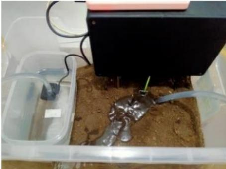
Gambar 21. Pengujian penyiraman pada tanah kering
