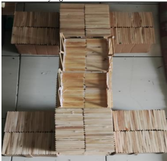
Gambar 14. Tampak atas kerangka jembatan yang terbuat dari stik es
