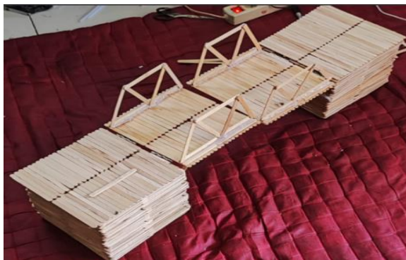
Gambar 13. Tampak samping kerangka jembatan yang terbuat dari stik es
