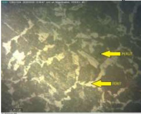
**Gambar 3.** Struktur mikro baja aisi 1045 sebelum perlakuan panas etsa: nital 5% dan *alcohol* 95%, persentase: fasa perlit 80.48% dan ferit 19.52%, perbesaran 200x
