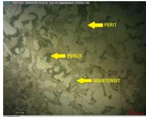
**Gambar 4.** Struktur mikro baja aisi 1045 setelah perlakuan panas etsa: nital 5% dan *alcohol* 95%, persentase fasa: martensit 35.45%, ferit 45.67%, dan perlit 18.88%, perbesaran 200x
