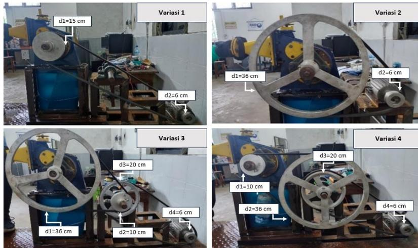
Gambar 1 Realisasi Rangkaian Transmisi
