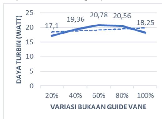
Gambar 2 Hubungan rata-rata variasi *guide vane* terhadap daya turbin
