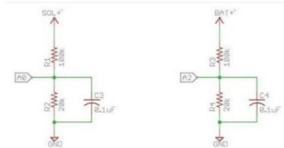
Gambar 8 Rangkaian Pembagi Tegangan
