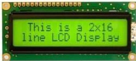
Gambar 8. LCD 16x2
