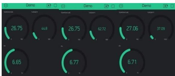
Gambar 13. Tampilan data sensor di Blynk
