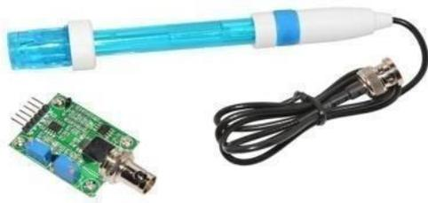
Gambar 7. Sensor pH-4502C
