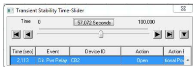
Gambar 26. bekerjanya CB 2 Pada detik 2,113 setting (Droop Governor Generator 1 = 1%) dan (Droop Governor Generator 2 = 1%)
