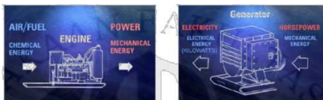
Gambar 3. konsep energi kimia ke energi mekanis kemudian listrik
