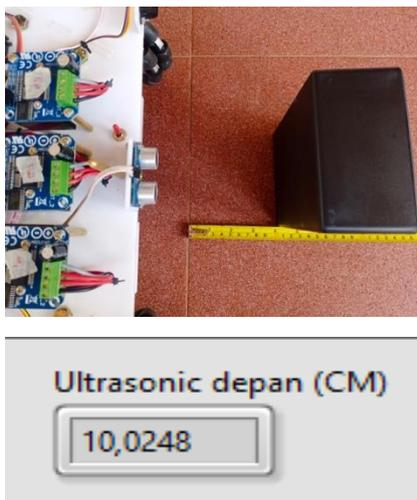
Gambar 17. Pengujian Sensor Ping Jarak 10 cm
