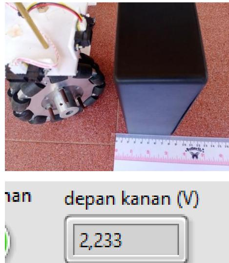
Gambar 18. Pengujian Sensor Sharp Jarak 2 cm
