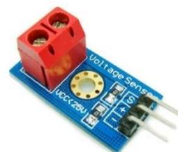
Gambar 4. Sensor Tegangan DC 25V
