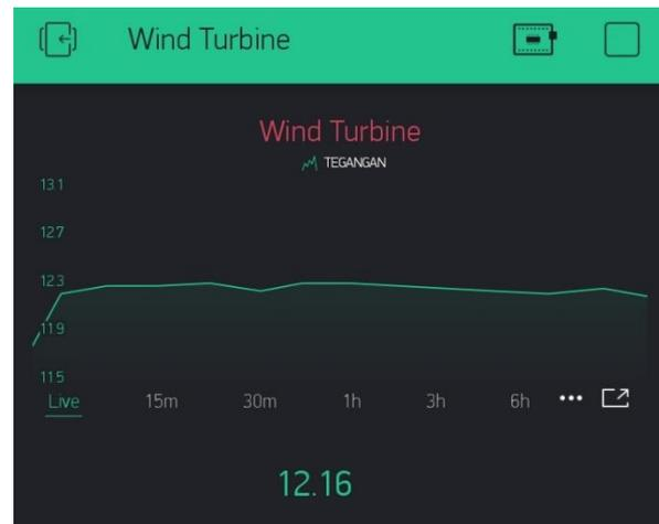
Gambar 19 Grafik nilai tegangan Charging baterai pada Blynk
