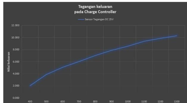
Gambar 14. Grafik tegangan keluaran pada Charge Controller
