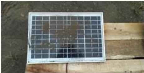
Gambar 16. Solar Cell Tertutup Debu Tebal
