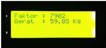
Gambar 7. Nilai Kalibrasi Load Cell
