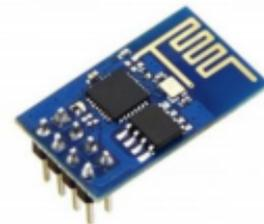
Gambar 2. Modul ESP8266
