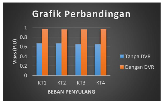
Gambar 13. Perbandingan sebelum dan sesudah pemasangan DVR pada saat terjadinya gangguan dua fasa ke tanah
