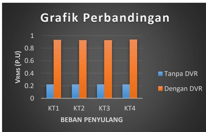
Gambar 14. Perbandingan sebelum dan sesudah pemasangan DVR pada saat terjadinya gangguan tiga fasa ke tanah
