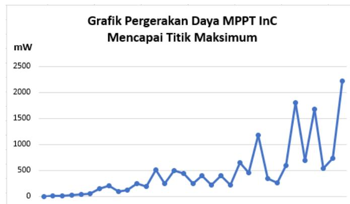
Gambar 22. Grafik Pergerakan daya MPPT Mencapai Titik Maksimum pada Beban 54,4 Ohm
