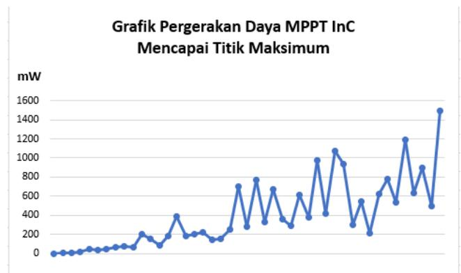
Gambar 25. Grafik Pergerakan daya MPPT Mencapai Titik Maksimum pada Beban 81,4 Ohm
