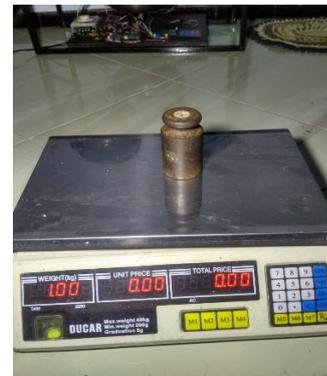
Gambar 14. Hasil Pengujian Timbangan Digital Konvensional dengan berat beban 1 kg
