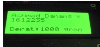
Gambar 16. Hasil Tampilan LCD Pada Alat Timbangan dengan beban 1 kg
