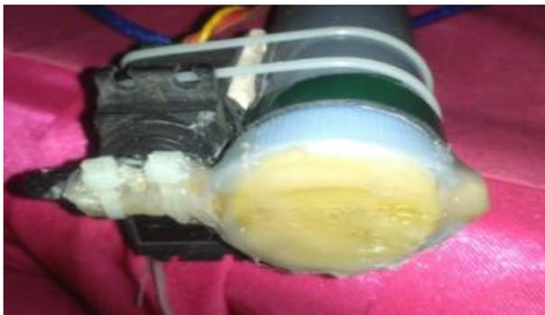
Gambar 17. Pengujian Servo sebagai katup dengan kondisi nol derajat atau kondisi tertutup
