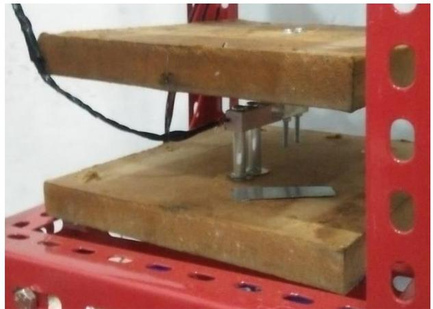
Gambar 17. Sensor Load Cell
