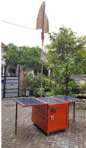
Gambar 23. Pembangkit Listrik *Portable* Alam
