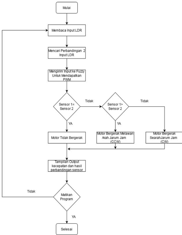
Gambar 13. Flowchart Cara Kerja Rangkaian
