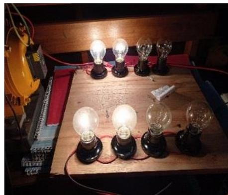
Gambar 23. Kondisi beban pada frekuensi 50,65 Hz
