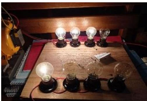
Gambar 27. kondisi beban pada frekuensi 50,38 Hz
