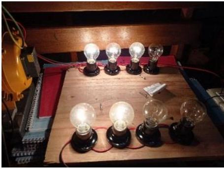
Gambar 25. Kondisi beban pada frekuensi 48,81 Hz
