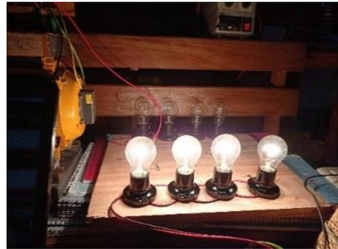
Gambar 14. Kondisi beban pada frekuensi 50 Hz
