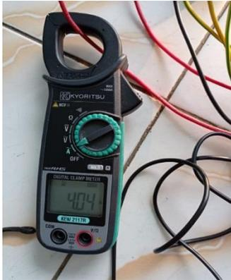
Gambar 12. Pengukuran menggunakan tang ampere
