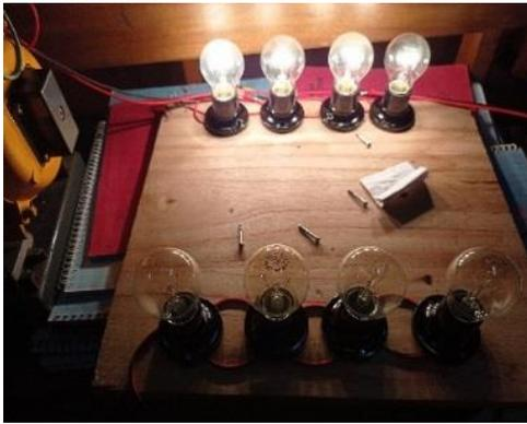
Gambar 31. Kondisi beban pada frekuensi 50,53 Hz
