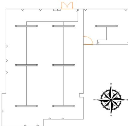
Gambar 3. Letak Lampu di Laboratoium Otomasi dan Robotika
