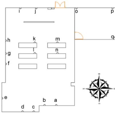
Gambar 2. Letak Outlet di Laboratoium Otomasi dan Robotika
