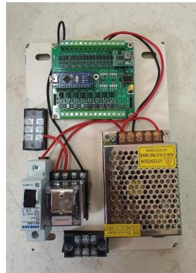
Gambar 17. Panel Kontrol Daya Kepala Lab Otomasi
