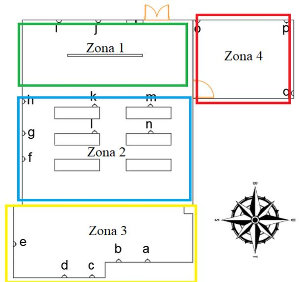
Gambar 11. Zonasi Sensor PIR pada Laboratorium Otomasi
