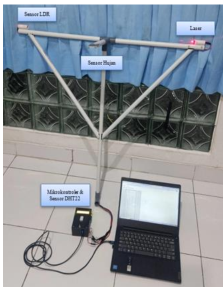
Gambar 5. Desain Alat Monitoring Cuaca
