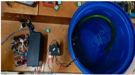
Gambar 19. Pengujian Beban Pompa Air
