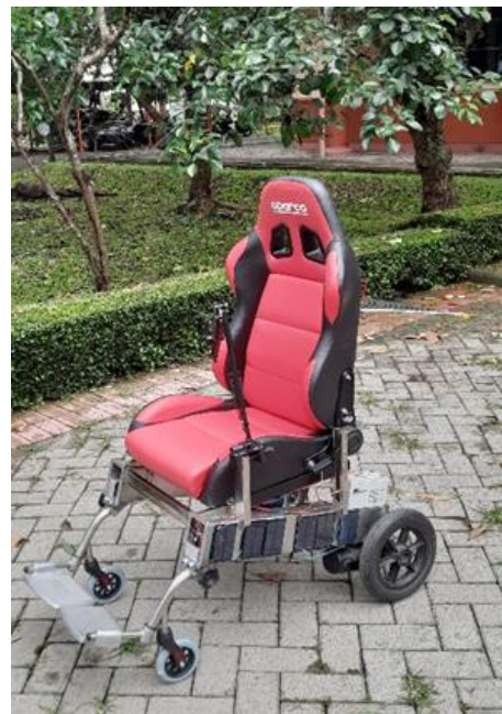
Gambar 18. Kursi roda elektrik berbasis Android
