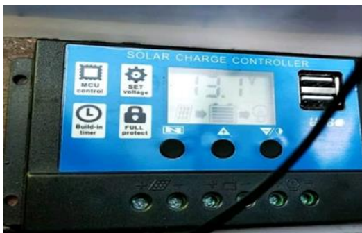
Gambar 20. Hasil Baterai Dari Panel Surya Pada SCC
