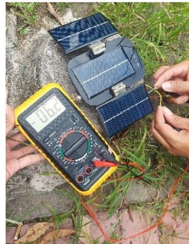
Gambar 14. Langkah pengujian panel surya
