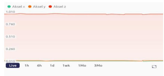
Gambar 15. Data axis accelerometer dalam keadaan diam pada smartphone
