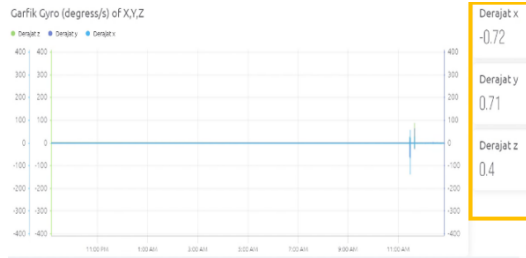
Gambar 8. Data axis gyroscope dalam keadaan diam pada website
