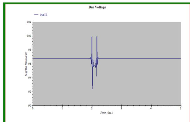
Gambar 5. Busbar 72 setelah Integrasi PLTS
