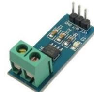
Gambar 6. Sensor arus module ACS712
