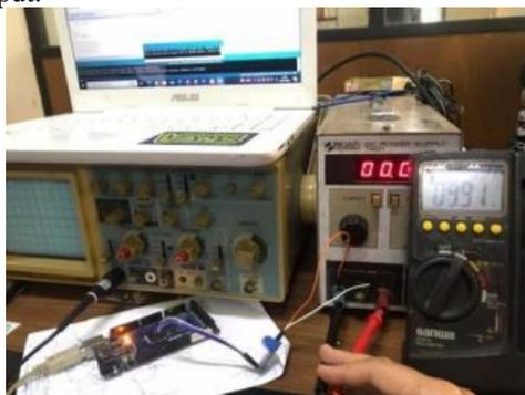
Gambar 23 Pengujian Sensor Tegangan
