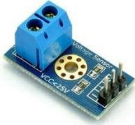
Gambar 7. Sensor tegangan DC
