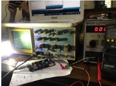
Gambar 22 Pengujian sensor Arus
