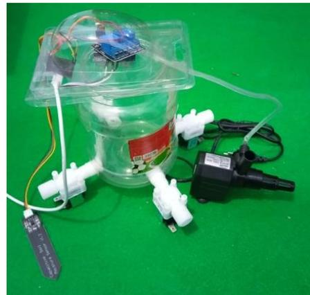
Gambar 13. Prototipe Rangkaian Alat
