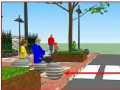
Tempat duduk berbentuk bulat untuk memberi kesan dinamis yang terbuat dari beton cetak atau pasangan batu, yang kemudian diberi finishing dengan cat warna cerah.
