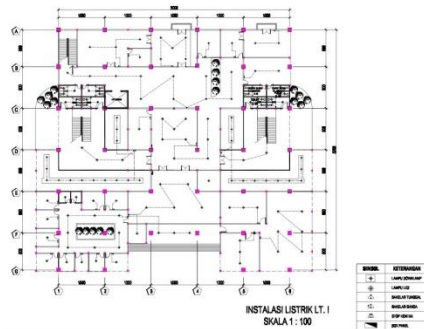
Gambar 25 Sumber: (Design Pribadi, 2019) Rencana Instalasi Listrik lantai 1
