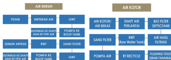
Diagram 2. Konsep Air Bersih dan Kotor.
