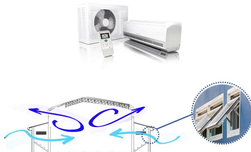
Gambar 19. Sistem bukaan alami pada bangunan
