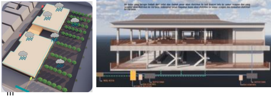
Gambar 9. Konsep Utilitas Air Kotor
